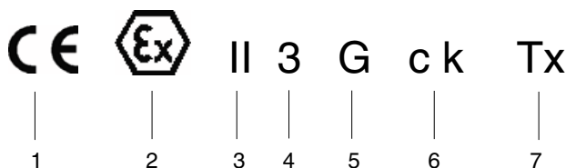
Abb. 15 Explosionsschutz-Kennzeichnung an der Pumpe (Gerätegruppe II, Kategorie 3)
